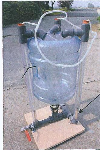
Durch die Luftzufuhr über die Ausströmer in den außenliegenden Steigrohren wird die Flüssigkeit ohne Druck umgepumpt und baut im Behälter einen Wirbel auf.
